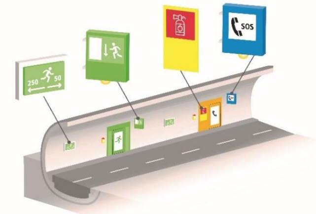
Schematische Darstellung der Sicherheitseinrichtung für den Verkehrsteilnehmer (Grundlage BAST – Bundesanstalt für Straßenwesen)
